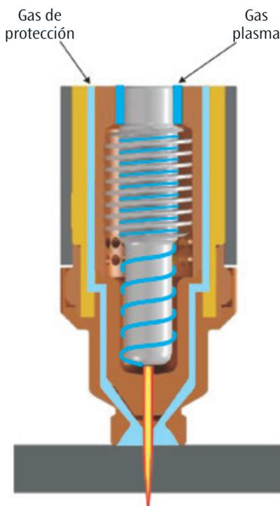
Las nuevas antorchas **High Performance Cutting SK** aumentan la densidad del haz de corte por plasma y reducen la anchura de la zona de corte del arco, produciendo un corte más estrecho y menos inclinado. Esto se logra fácilmente mediante la eliminación de material fundido con la consiguiente mejora de la calidad de corte, mostrando cortes impecables, sin escoria, mínima zona afectada por el calor y bordes suficientemente perfilados.
